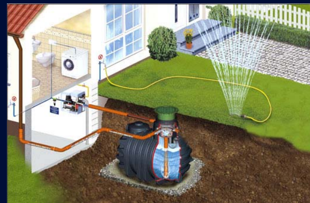
Uno schema del sistema di recupero delle acque piovane
